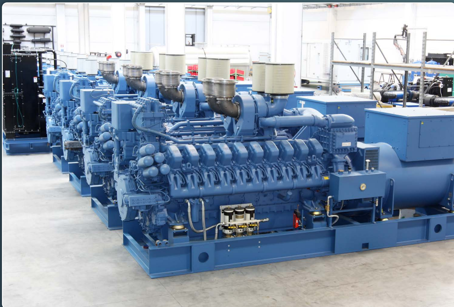
Энергокомплекс 10 МВт из ДЭС на двигателе MTU
